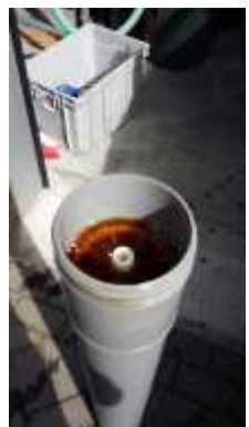
Inweken van het membraam in 5% MC11
